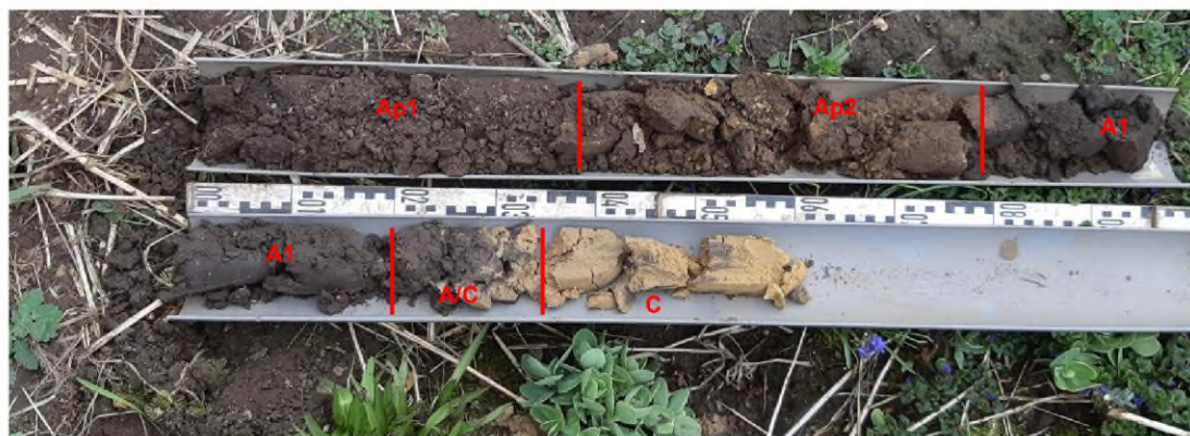
Afbeelding 15: Boring 1 met van links naar rechts en van boven naar onder het omgewerkte pakket (Ap1/Ap2), de eerdlaag (A1), de menglaag (A/C) en het dekzand (C).
