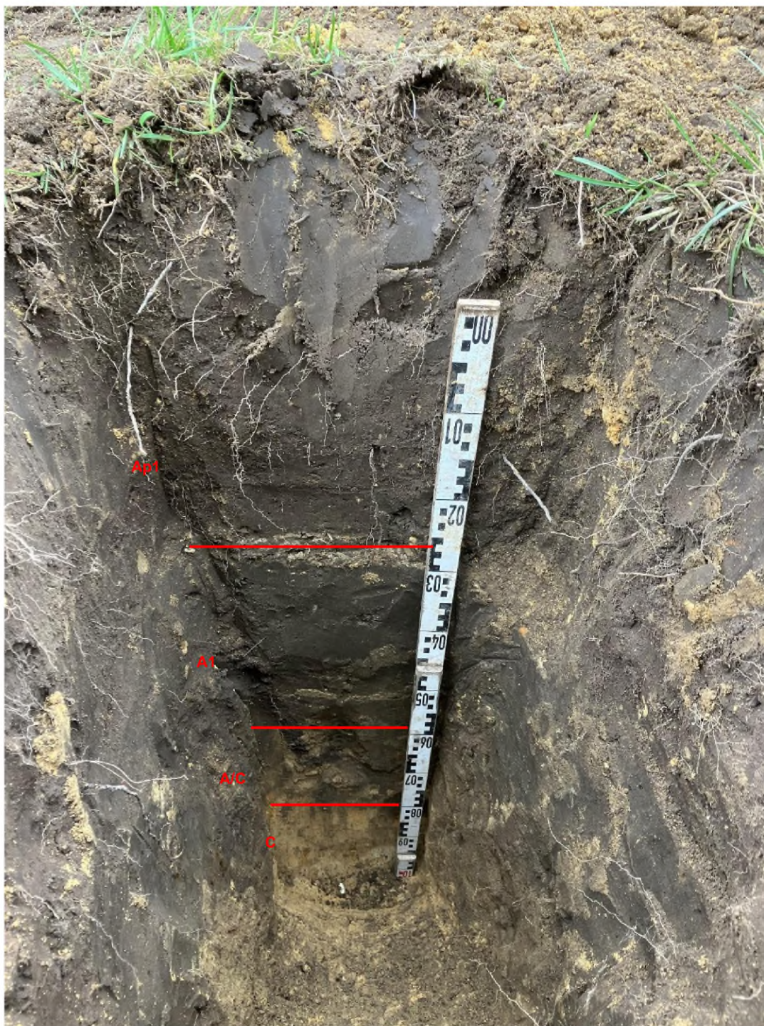
Afbeelding 16: Profielput met van boven naar onder het omgewerkte pakket (Ap1), de eerdlaag (A1), de menglaag (A/C) en het dekzand (C).
