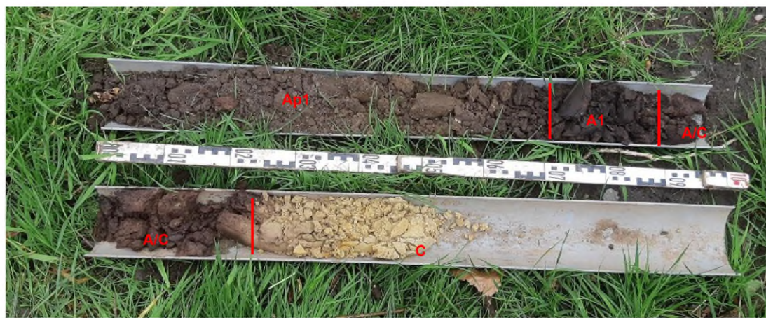
Afbeelding 14: Boring 4 met van links naar rechts en van boven naar onder het omgewerkte pakket (Ap1), de eerdlaag (A1), de menglaag (A/C) en het dekzand (C).
