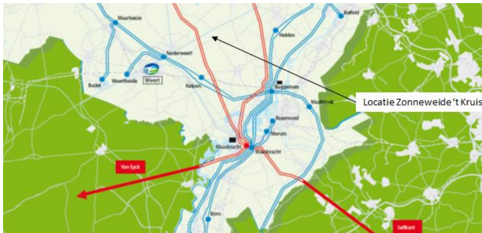
Figuur 9 De elektrische infrastructuur in de omgeving van Nederweert. Rode lijnen: 380 kV transportlijnen. Blauwe lijnen: 150 kV transportlijnen. Blauwe punten: 150kV-10kV onderstations. Bron: TenneT
