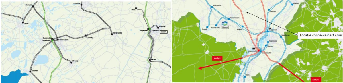
Figuur 10 Infrastructuur in het gebied rond Nederweert (rechts) vergeleken met een vergelijkbaar gebied in het noorden van het land (links). Niet alleen zijn er minder elektriciteitslijnen, de lijnen die er zijn (zwart en groen, oftewel 220 kV en 110 kV) zijn ook minder sterk dan de lijnen in Midden-Limburg (rood en blauw, oftewel 380 kV en 150 kV). Bron: TenneT.
